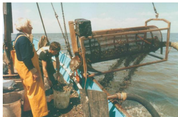
Figur 3: Mekanisk hjerteskjell høsting med sledepumpe.
